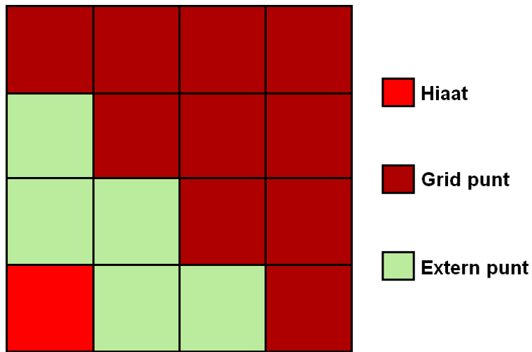
Figuur 98: Een voorbeeld van een hiaat die niet bijgeschat kan worden met de 'incrementele' interpolatie methode.
